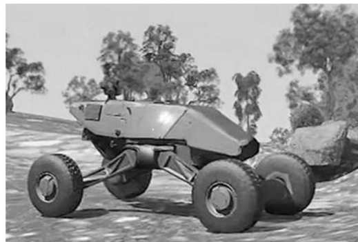
Рис. 1. Варіант високомобільної БМ проекту GXV-T
