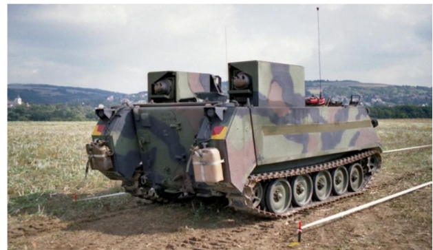
Рис. 2. Зовнішній вигляд пересувних димових генераторів на базі ПуПРД (США):
