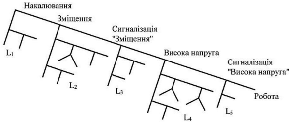
Рис. 3. Умовний алгоритм оцінки технічного стану підсистеми керування роботою радіопередавача
