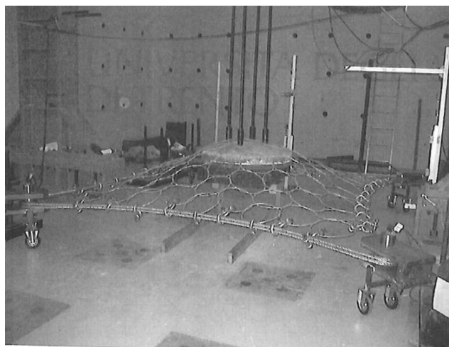
Рис. 7. Тест на розрив кільцевої сітки з дроту діаметром 2,0 мм (дріт оцинкований клас А, мінімальне навантаження на розрив 1770Н/мм 2 ), вічко 250 мм, плетіння в 7 жил, тип з'єднання 6 в 1
