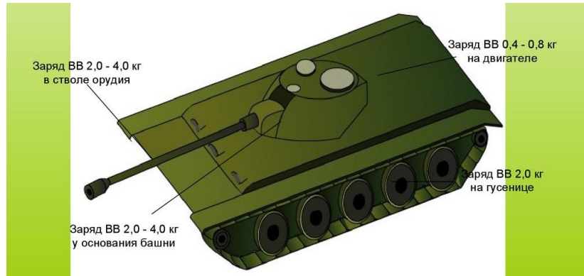
Рис. 3. Ілюстрація із довідника противника із вразливими місцями і масами контактних фугасних зарядів для встановлення на ОБТ (танк) при знищенні та псуванні матеріальної частини (відступ, диверсії тощо)
