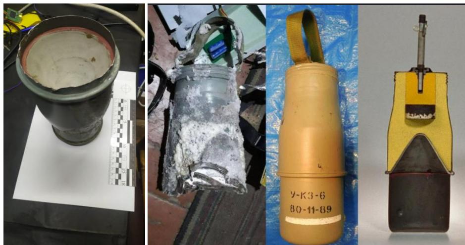
Рис. 2. Кумулятивний інженерний боеприпас КЗ-6, як БЧ у «Ланцеті-3» [7]
