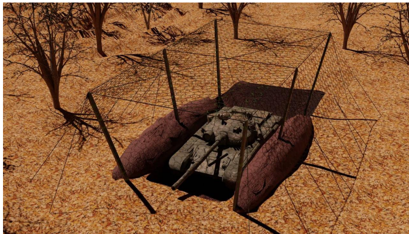
Рис. 6. Система укриття ОБТ під “Захисний екран/легка сітка “RingGuard” з натяжним каркасом” – екран із сіток та динамічний каркас з жорстких стержневих опор: перемичка (гнучка із сталевого канату діаметром 10 мм; сталева опорна стійка з профільної труби 80x80 мм; відтяжка зі сталевого канату 10 мм; опорний вузол відтяжки
