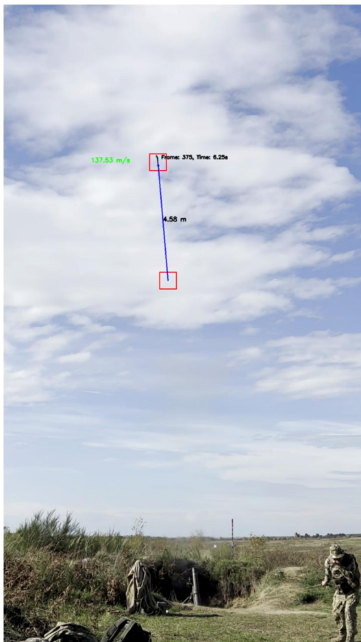
Рис. 4. Візуалізація методу визначення швидкості мінометного боєприпасу на основі комп'ютерного зору
