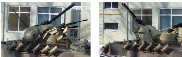
Рис. 16. 23-мм спарена артилерійська установка та бойовий модуль з ПКТ і АГС-17 на танку Т-64Е
