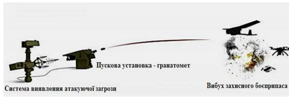
Рис. 14. Схема ураження БПЛА дистанційнокерованою платформою SARP
