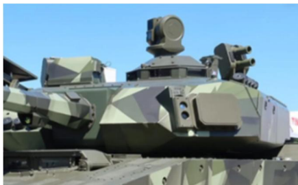
Рис. 5. Загальний вигляд САЗ «Iron Fist»
