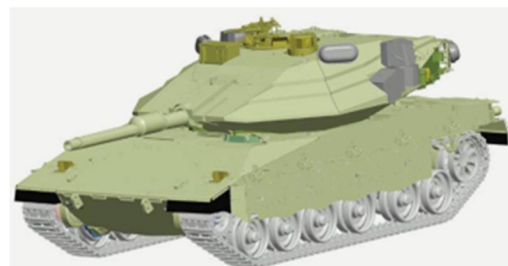
Рис. 3. Схема розташування КАЗ «Trophy» на ОБТ «Меркава» Mk 3
