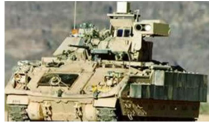
Рис. 1. БМП M2 Bradley з САЗ AN/VLQ-8
