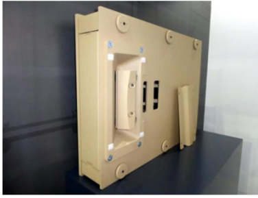
Рис. 8. Комплекс активного захисту, механічно інтегрований у гібридні броньові плити
