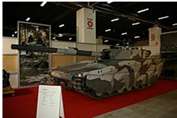
Рис. 1. CV90120, оснащений AMAP-ADS
